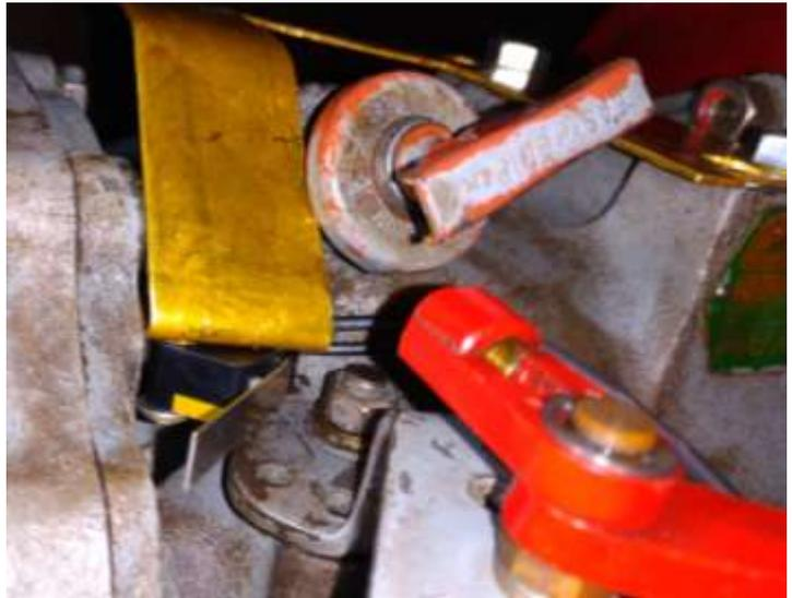
Mikroschalter an Messingblech Gangschaltungbetätigt
