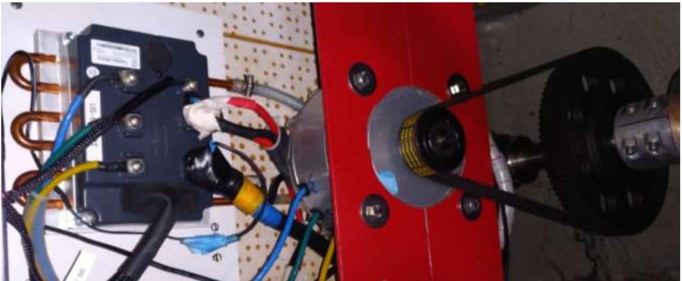
Antrieb Backbordseite Untersetzung 5:1; schwarz ist die Steuerelektronik für den Drehstrommotor 3kW
