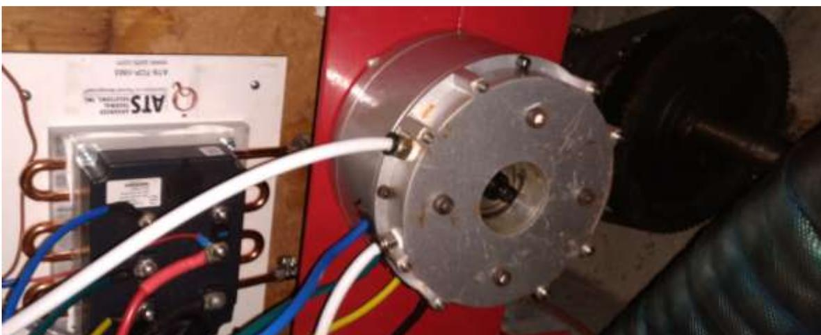
Antrieb Steuerbordseite, seitenverkehrt da die zwei Schraubenwellen gegenläufig drehen.
